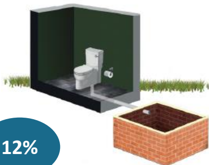
Baño con cámara
